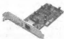
Рис. 2.5. Сетевой адаптер типа Ethernet
