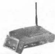
Рис. 2.6. Точка доступа и беспроводной сетевой адаптер
