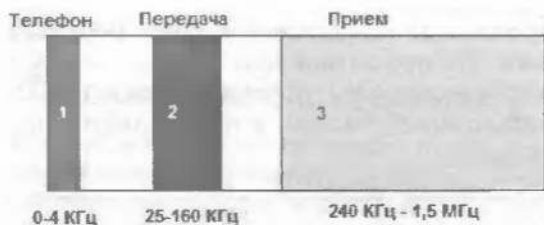
Рис. 2.8. Голосовая связь, передача и прием данных по телефонной линии по технологии ADSL
